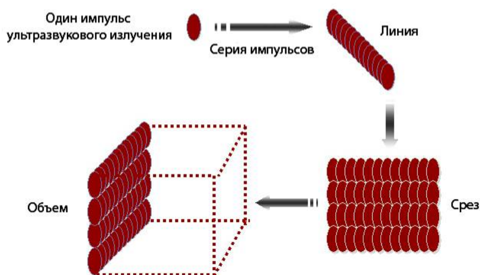
Рис. 6. Схема многосрезовой трехмерной ультразвуковой абляции. Последовательно импульсами пролечивается весь объем опухоли не зависимо от ее формы и размеров
