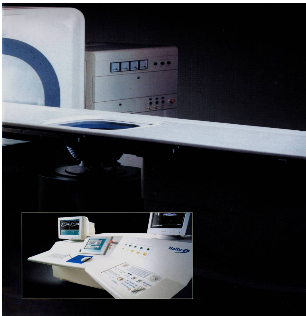
Рис. 2. Аппарат для экстракорпорального лечения опухолей человека. Лечебный и диагностический модули (в верхней части рисунка), модуль управления (в нижней части рисунка).
